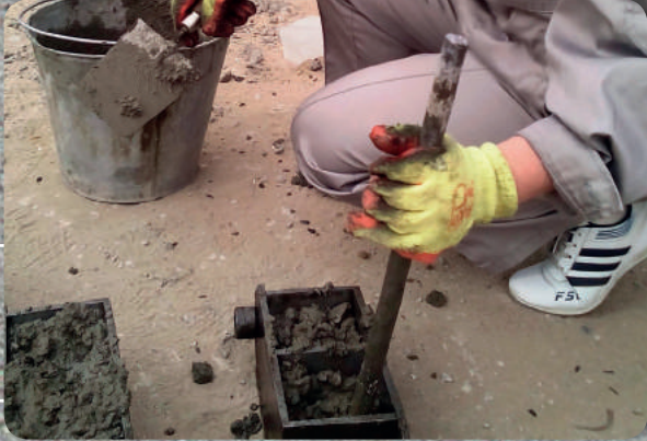
■ Изготовление образцов бетона.
