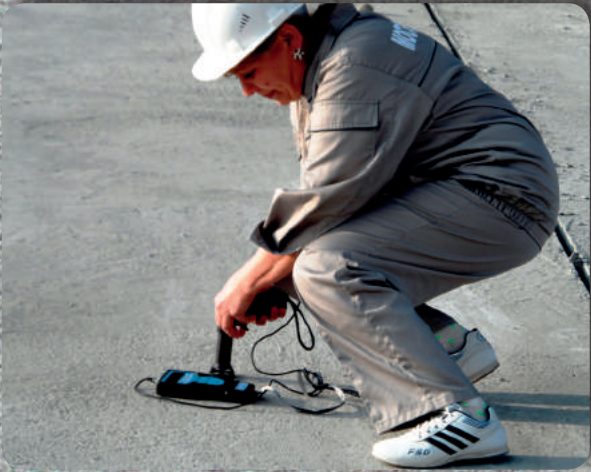
■ Проверка прочности бетона неразрывным методом прибором ИПС.
