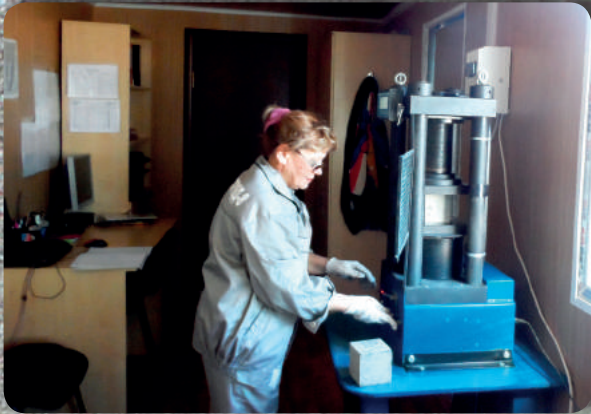
■ Проверка прочности бетона.
